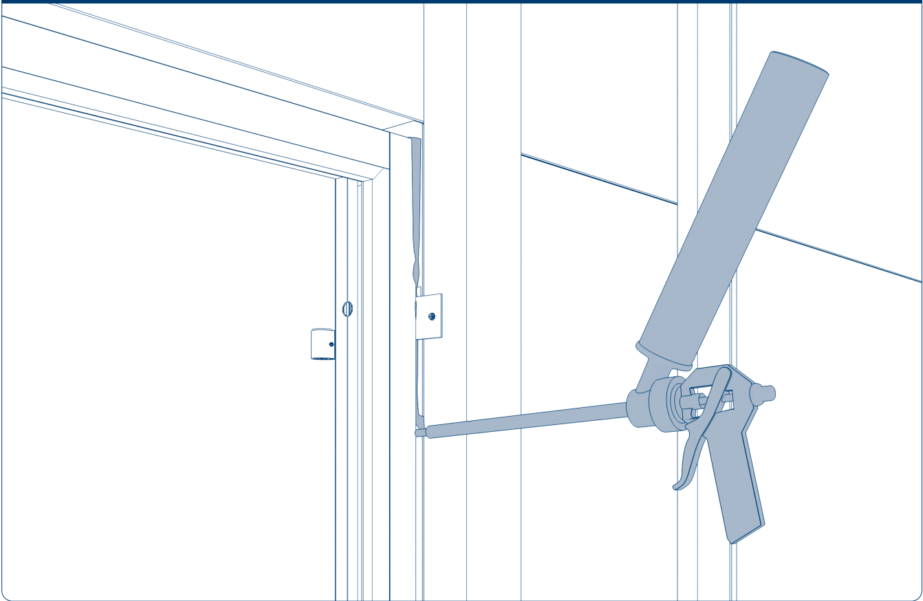
Рис. 11.10. Заполнение зазоров монтажной пеной
